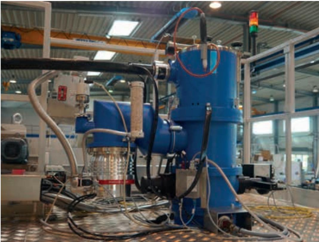
HiPace Turbomolekularpumpe Turbo am Elektronenstrahlgenerator (Mit freundlicher Genehmigung von Steigerwald Strahltechnik)
